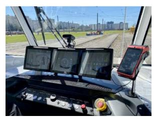
**планшет водителя** - устройство, сигнальные показания которого регулируют движение подвижного состава;
